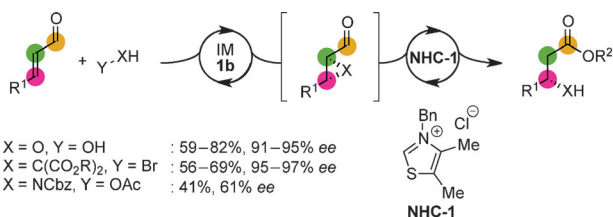
Schema 15. Sequenzielle Iminiumion- und NHC-katalysierte Bildung von \beta -funktionalisierten Estern.
